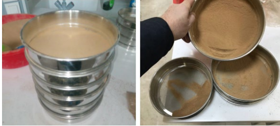
Şekil 4. Ceviz kabuklarının titreşimli elek makinesine konulması ve eleme işlemi sonrası elde edilen farklı tane boyutundaki toz ceviz kabukları görüntüsü
