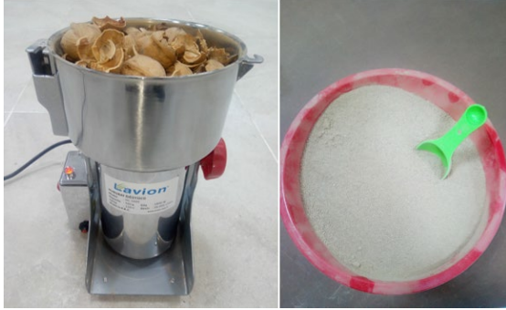
Şekil 3. Ceviz kabuklarının kırıcı/öğütücü değirmene konulması ve öğütülme sonrası elde edilen toz ceviz kabukları
