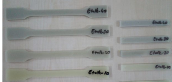
Şekil 7. Kalıplardan çıkarılan talk dolgulu epoksi numunelerinin resimleri
