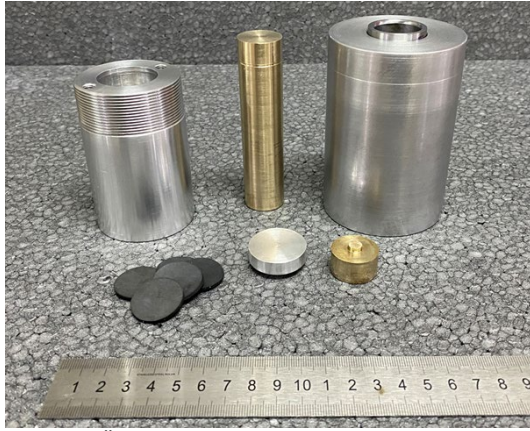
Şekil 2. Üretilen parçaların gerçek resimleri. Not: Kovan dışında bir alüminyum silindir (en sağda) ısı tutucu olması ve kovana sabitlemesi amacıyla sonradan eklenmiştir.
