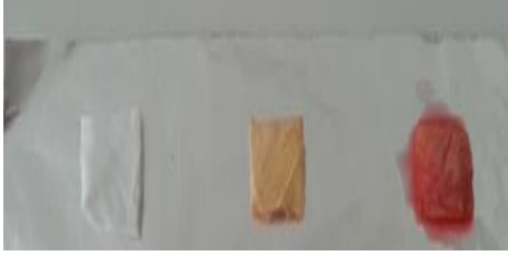
Şekil 5. a) Elektroeğirme yöntemi ile elde edilen PS nanolifi, b) kompleksleştirici emdirilmiş PS nanolifi, c) Pb(II) iyonu ile kompleksleşmiş PS nanolif.
