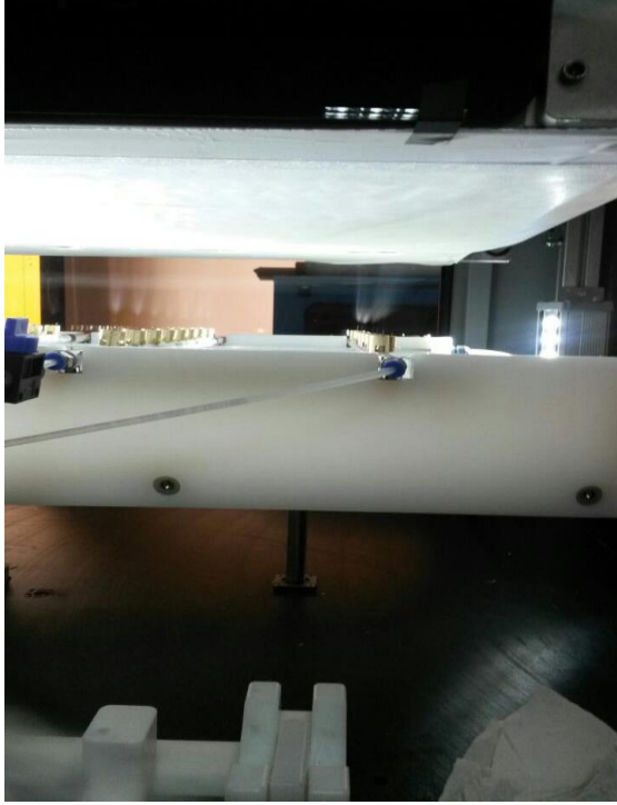
Şekil 1. Blok üzerindeki nozulların elektro-üretim sırasında çalışması
