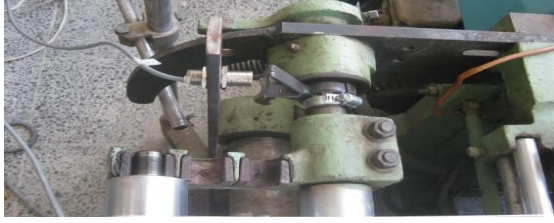
Şekil 1. Arka köprüye takılan yer değiştirme sensörü
