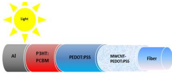
Şekil 1. Organik güneş pilinin sematik gösterimi
