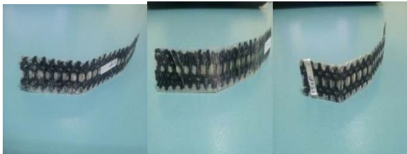
Şekil 10. Poliester esaslı tavuk tüyü takviyeli kompozit malzemelerin eğime mukavemeti
