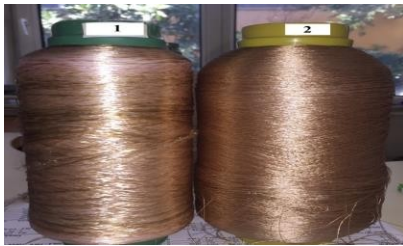
Şekil 1: 1-Fikse + %2 Enzim ile yapılan ön işlem sonrası boyama, 2-Fikse + Referans boyama
