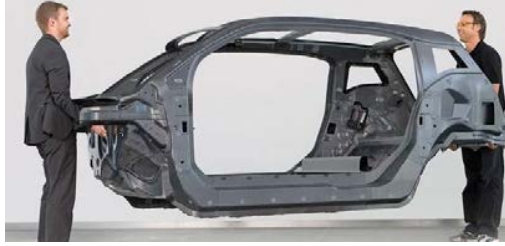
Şekil 3: BMW i3 için geliştirilmiş hafif araç gövdesi (SGL Carbon, 2017)
