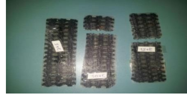
Şekil 3. Epoksi esaslı tavuk tüyü takviyeli kompozitlere çekme testi uygulandıktan sonraki görüntüler
