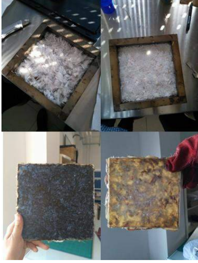
Şekil 1. Kırılmış bazalt elyaf (resimde sol alt) ve cam elyafla (resimde sağ alt) takviye edilmiş PA matriksli kompozit plakalar.
