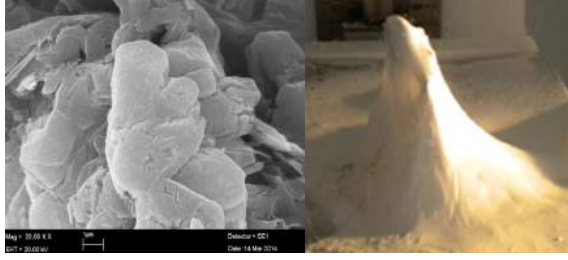
Şekil 1. 17 kV voltaj, 8 cm toplayıcı-iğne ucu mesafesi, 5 ml/saat çözelti besleme hızı, pH 4 değerinde 300 dakikada üretilmiş 3D nanoliflerin SEM ve Kamera görüntüleri (3:1 Maleik/Tanik)
