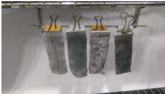
Şekil 3. Sırasıyla kütlece %0.47, 0.76, 1.10 ve 1.57 rGO kaplı PVDF nanolifler.
