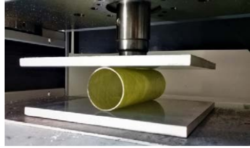
Figür 2: Radyal Basma Testi Kurulumu
