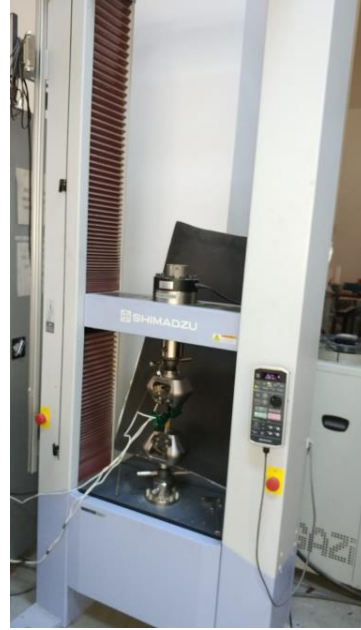
Şekil 6. Çekme test cihazı ve ekstansiyometre
