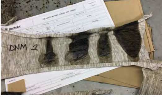
Şekil 9. Deneme 2 OKEY- Örülen numunelerin test sonucu görünümü
