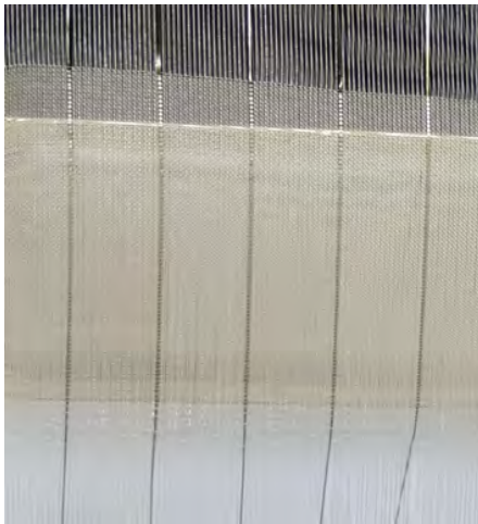
Şekil 5. Güç tutuşur iplikler arasında bariyer oluşturan bazalt
