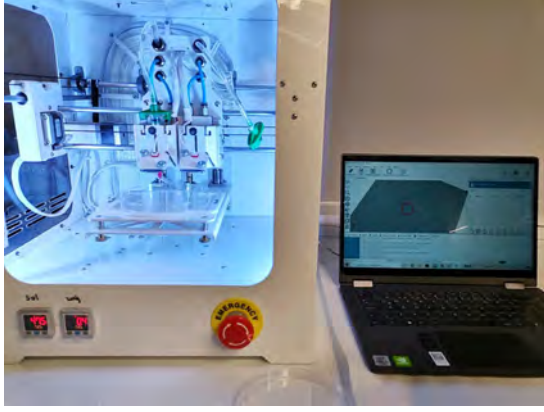
Şekil 1. Axodual mikroekstrüzyon modeli biyoyazıcı ve Repetier yazılımı ile yapay doku iskeletinin modellenmesi
