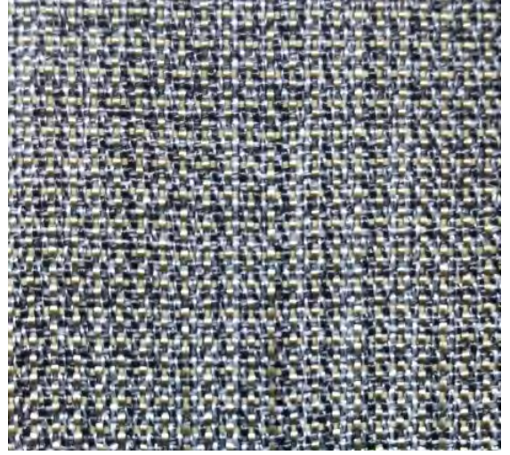
Şekil 6. Güç tutuşur ipliklerle bazalt birleştirilerek yapılan kumaş
