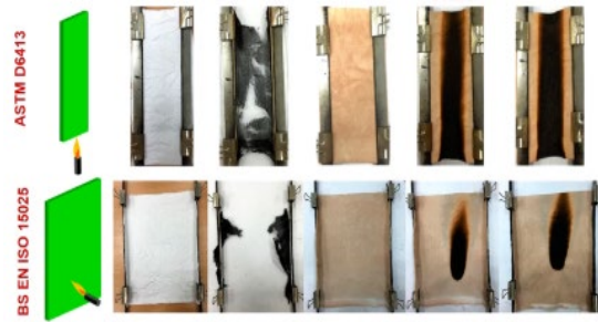
Şekil 2: ASTM D6413 (üstte) ve BS EN ISO 15025 (altta) uyarınca gerçekleştirilen yanıcılık testlerinden önce ve sonra işlem görmemiş ve PApP kaplı kumaşların görüntüleri 29 .
