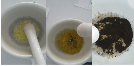
Şekil 2. Mekanokimyasal yöntemle manyetik zeolit sentezi
