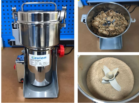
Şekil 5. Fındık kabuklarının öğütülmesinde kullanılan öğütücü değirmen ve ceviz kabuklarının öğütülmesi
