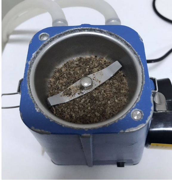
Şekil 12. Ceviz kabuğu katkıli PLA granül boyutlarının öğütme işlemi ile <40 mikron altına indirilmesi
