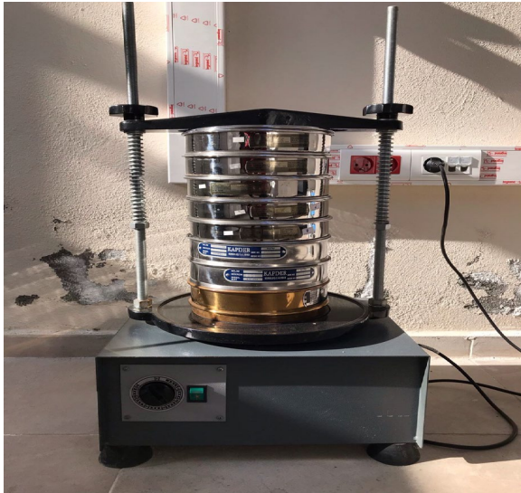
Şekil 6. Ceviz kabuklarının elenmesinde kullanılan cihaz ve eleme işleminin görüntüsü
