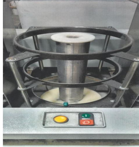
Şekil 9. Kalın iplik üretimi için tasarlanmış makine üzerindeki bilezik, masura ve kopça örnekleri
