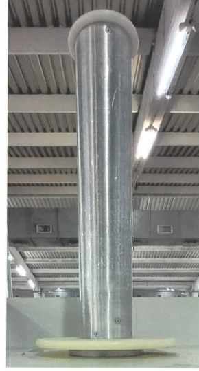
Şekil 4. Katlama ve büküm işleminin yapıldığı flatör makinesine ait masura örneği
