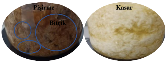
Şekil 6. Kasar işlemi sonrası bitçiklerin yok olması
