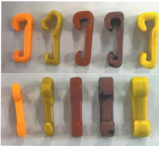
Şekil 8. Kalın iplik üretimi için uygun kopça tasarımı örnekleri
