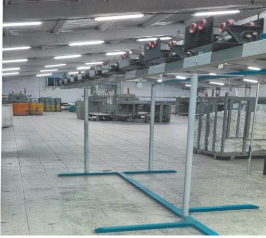
Şekil 6. 'Fital koptu' sensör porselen kılavuzları ve 'fital koptu' sensör grup gövdesi
