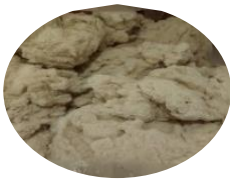
Şekil 1. Filtre sisteminden toplanan klima tozu atıkları
