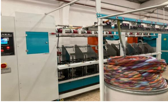
Şekil 2. Kalın iplik üretimi için tasarlanmış flatör makinesi
