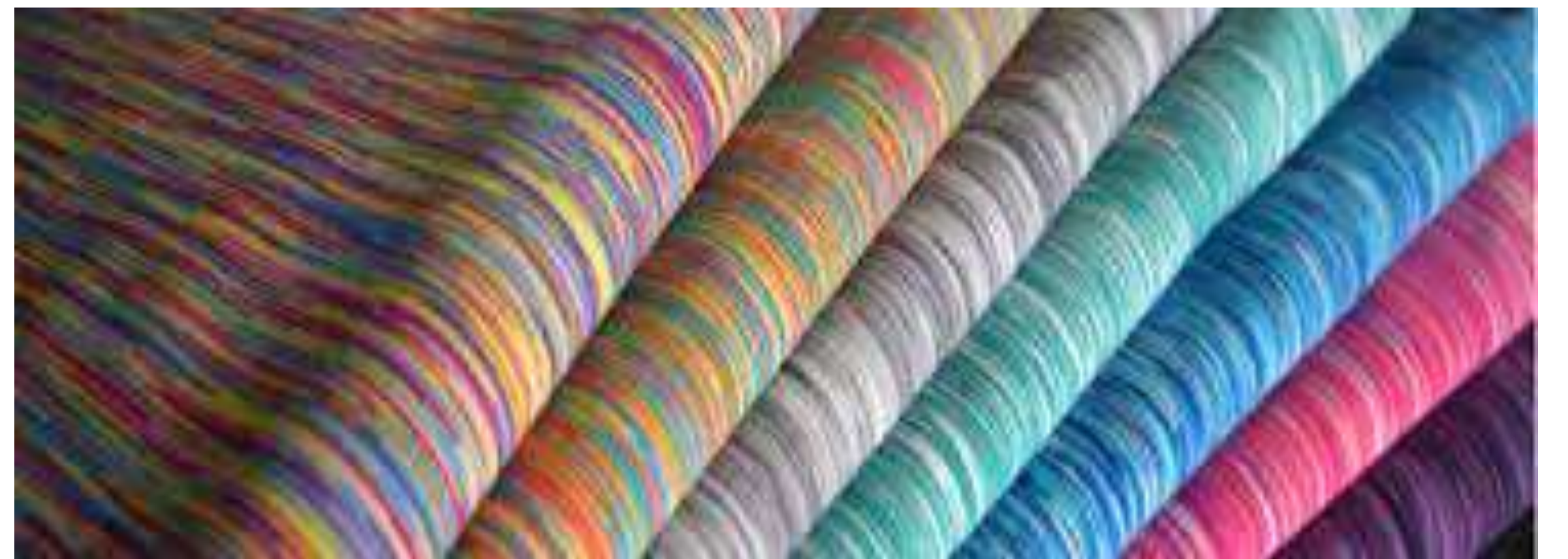
Şekil 3. Degrade ipliklerle dokunmuş bir kumaşın görünümü
