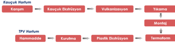
Şekil 1. Kauçuk hortum ve TPV hortum üretimi proses adımları
