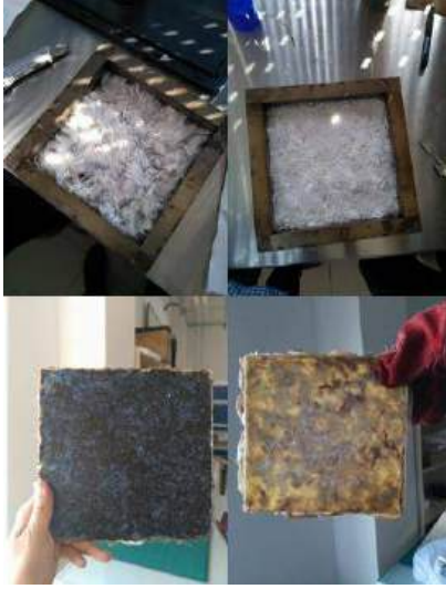
Şekil 1. Kırılmış bazalt elyaf (resimde sol alt) ve cam elyaf (resimde sağ alt) takviye edilmiş PA matriksli kompozit plakalar.
